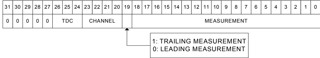
Fig. 6.7: Output buffer: CSM data format
